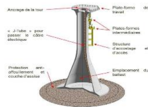
Figures 5 et 6 : Schéma de principe d'une fondation (à gauche) et de ses dimensions (à droite) (source : Etude d'impact)
